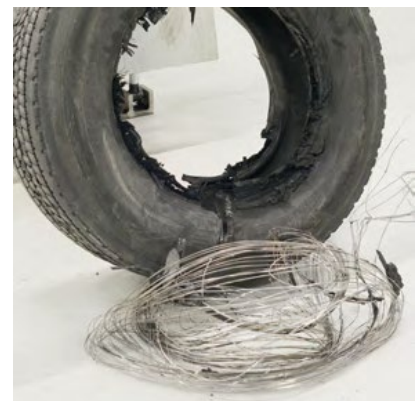
Slika 45. Čelične perle izvučene iz gume[45]
