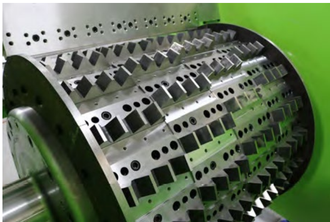
Slika 32. Izgled noževa u sekundarnom šrederu [32]
