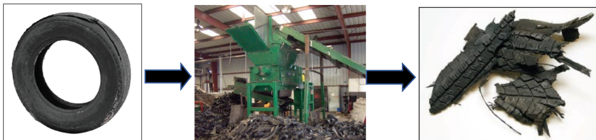
Slika 30. Prikaz otpadnih guma prije i nakon drobljenja u primarnoj drobilici (šrederu) [37]
