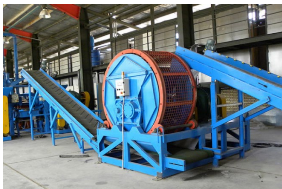
Slika 26. Primarni šreder sa sitom za ponovno vraćanje krupnijih komada [33]
