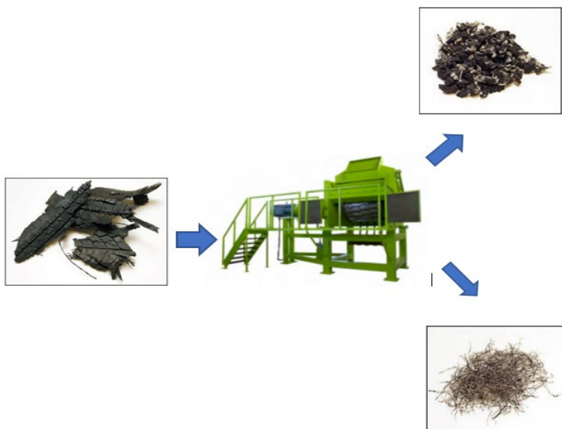
Slika 33. Prikaz ulaznih i izlaznih proizvoda u/iz sekundarnog šredera
