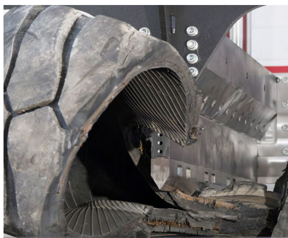
Slika 47. Postupak rezanja OTR gume [45]
