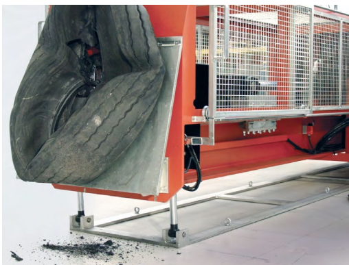
Slika 44. Postupak izvlačenja čeličnih perli[45]
