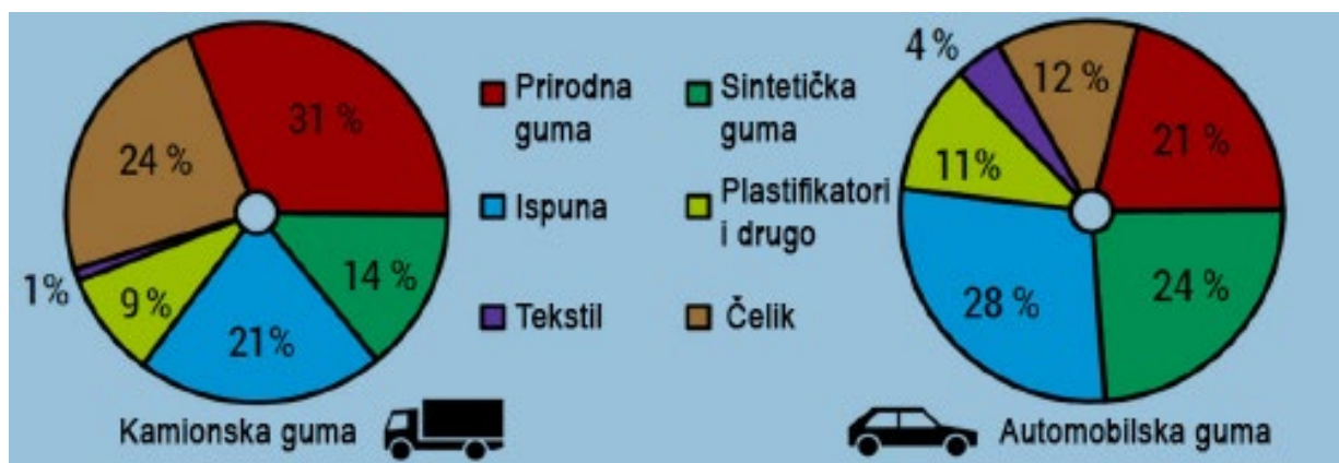
Slika 1. Prosječan materijalni sastav cijelih kamionskih i automobilskih guma [5]
