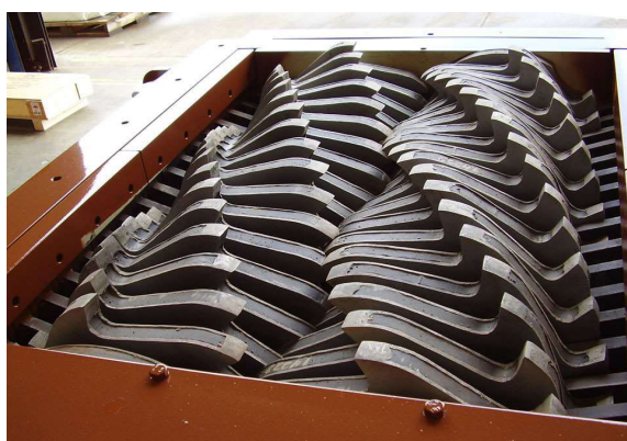
Slika 29. Primarni šreder sa dvije osovine [36]
